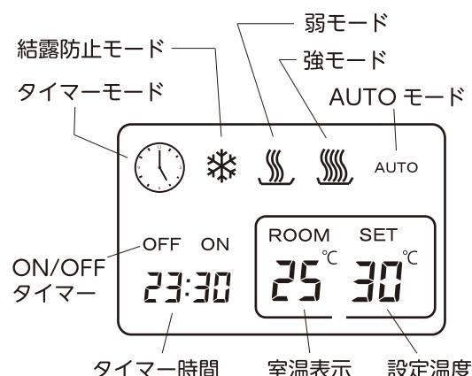
※運転表示パネルのバックライトは、操作パネルの最終操作後、約 30 秒で暗くなります。再度操作ボタンを押すと明るくなります。
