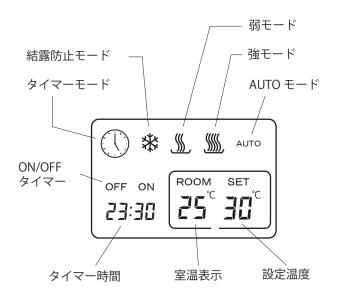
**弱モード**: ヒーター 600W(ミニ:250W)で運転 **強モード**: ヒーター 1000W(ミニ:500W)で運転 AUTO モード:室温 18℃ 以下で強モードで動作
