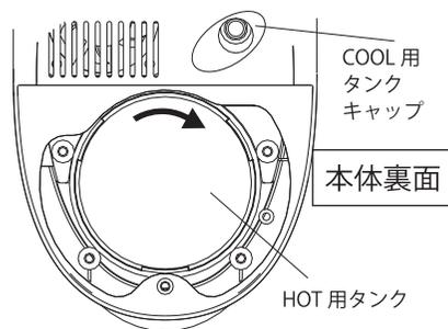
HOT用タンクを時計方向へ回し固定します。
